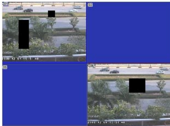
現場畫面遮罩區域
