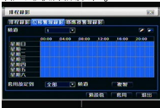
Fig 3-16 排程錄影-位移警報錄影
